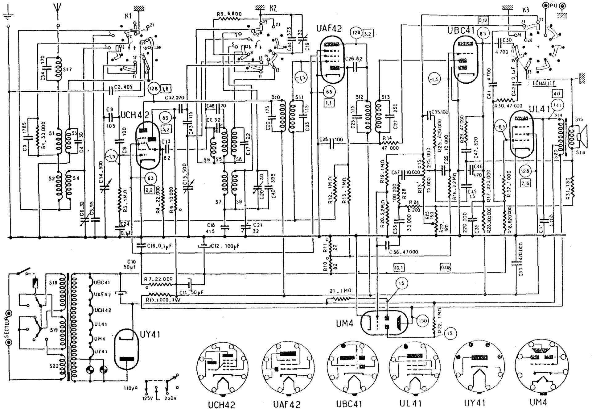
La résistance de filtrage de 1.000 ohms, 3 watts a été, par erreur, marquée R<sub>15</sub> au lieu de R<sub>5</sub>
