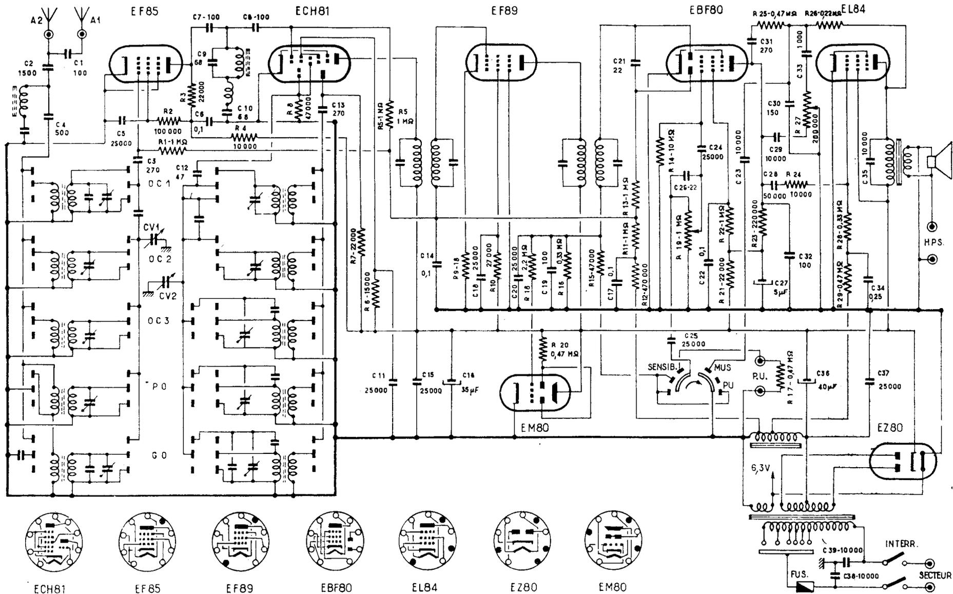
Ce récepteur ne se distingue du modèle « Confort VI Antenne » que par l'adjonction d'un étage amplificateur H.F. « semi-apériodique » équipé d'une EF85. La résistance de
