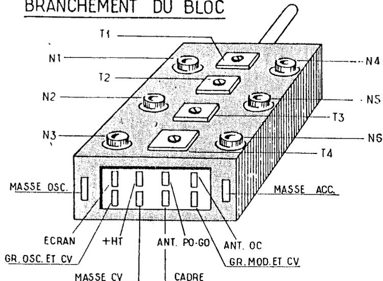
A gauche : disposition des différents réglages sur le bloc du récepteur « Fugue ».
