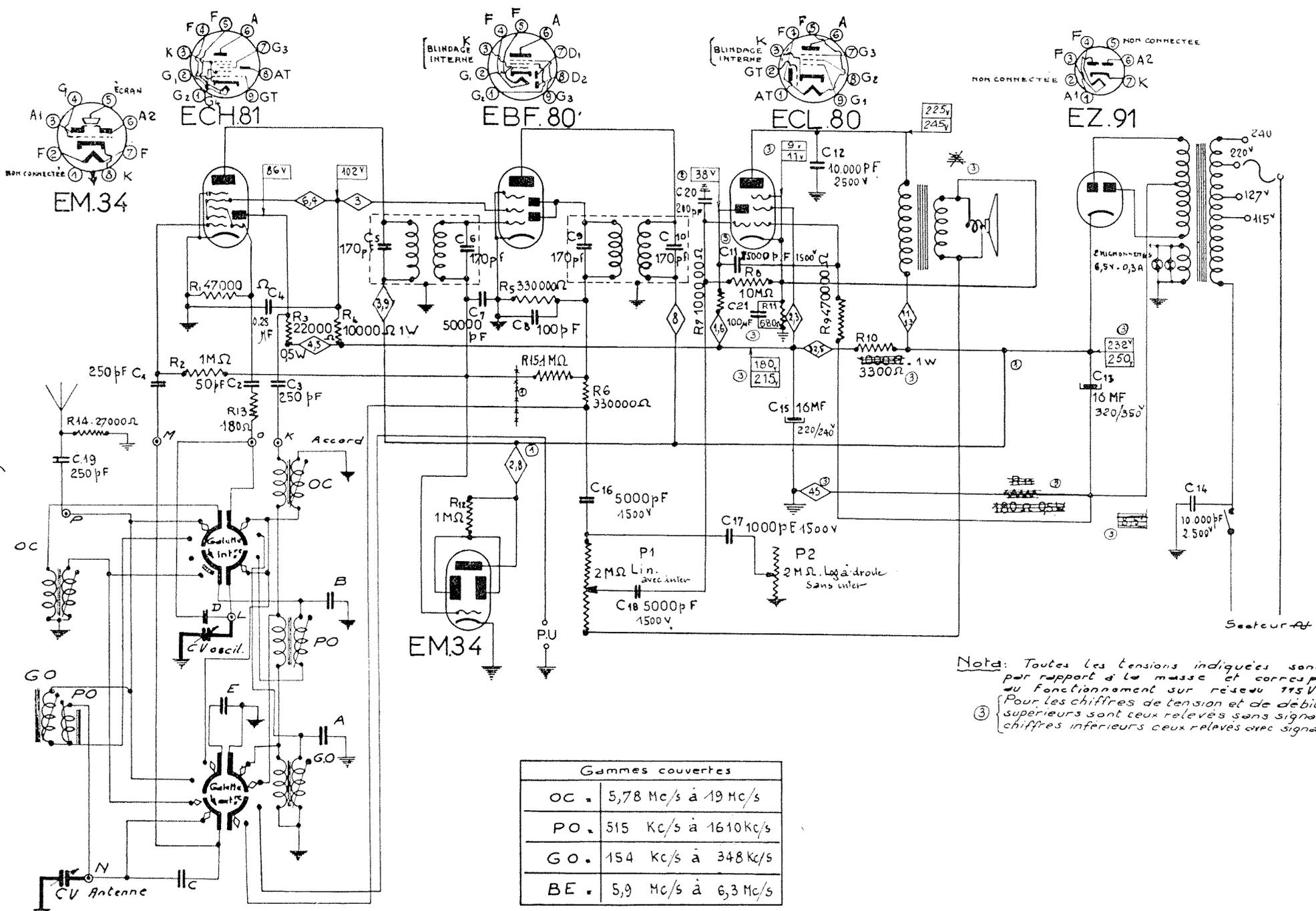
Nota: Toutes les tensions indiquées sont mesurées par rapport à la masse et correspondent au fonctionnement sur réseau 115V AC.
