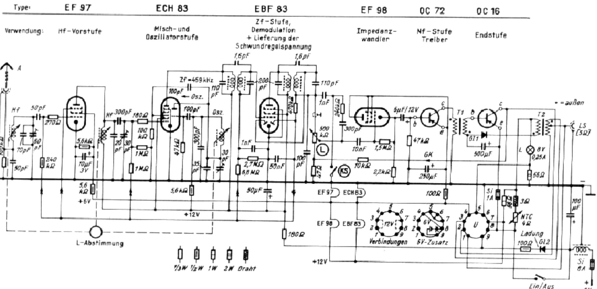
Schaltung des Autospeakers „Transistor-Baby“ der österreichischen Firma HEA. Der Empfänger arbeitet im Hf- und Zf-Teil mit den neuen Autosuperröhren und im Mf-Teil mit Transistoren, wobei eine EF 98 als Impedanzwandler im Eingang dient. Als Stromquelle dient nur die 12-V-Wagenbatterie; bei Wagen mit 6-V-Batterie ist eine kleine Zusatzbatterie erforderlich
