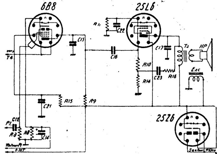
Celui-ci peut être substitué sur le D.-R.-S., à la portion du schéma de principe comprenant les lampes 6Q7, 25L6, 25Z6.
