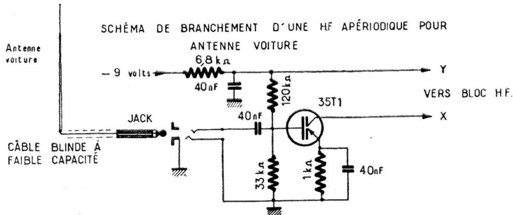
L'emploi de ce préamplificateur est conseillé lorsqu'on se propose de faire fonctionner le récepteur à l'intérieur d'une voiture. On obtient de cette façon un accroissement de gain très appréciable.
