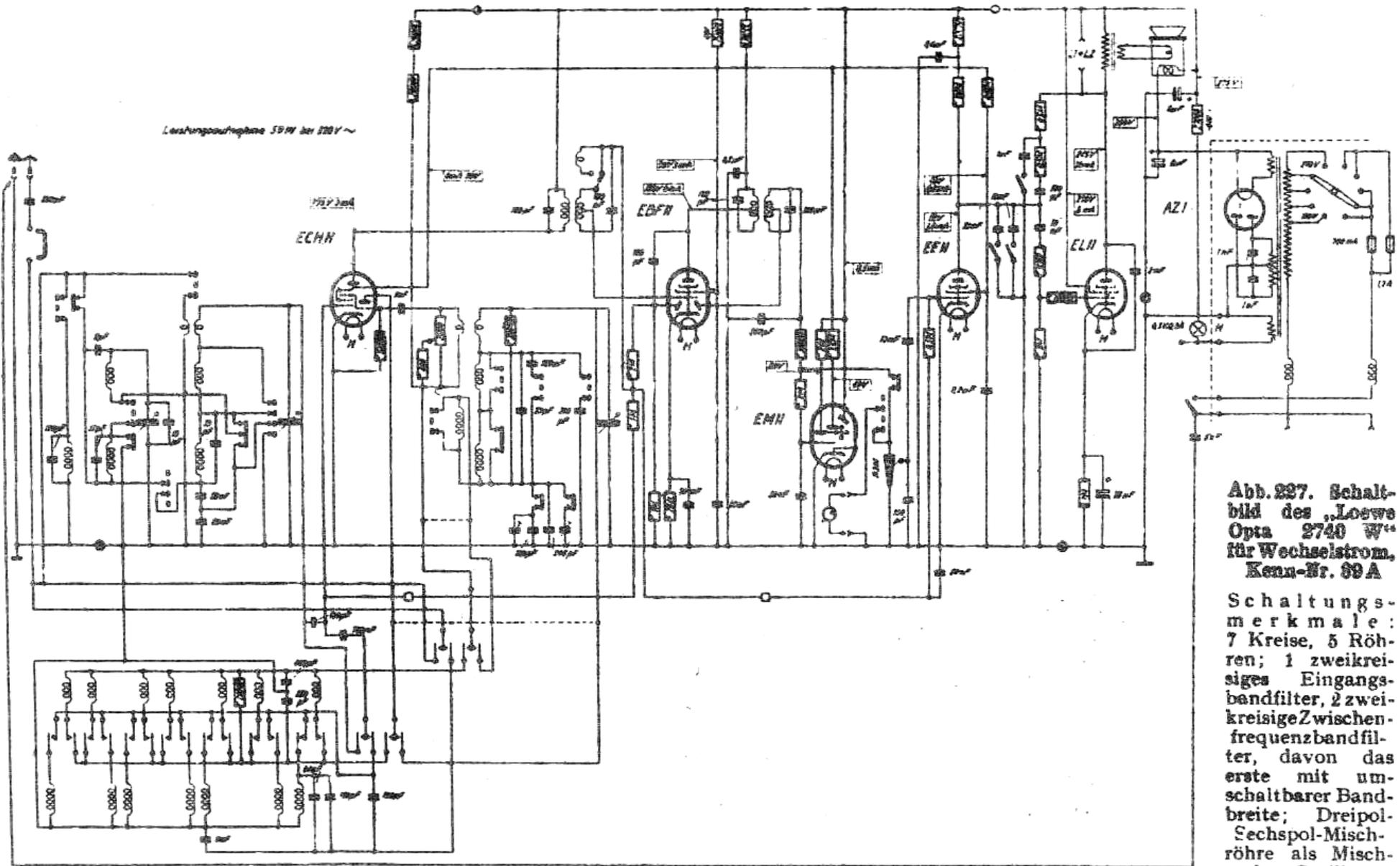
Abb. 227. Schaltbild des „Loewe Opta 2740 W“ für Wechselstrom, Kenn-Nr. 69 A
