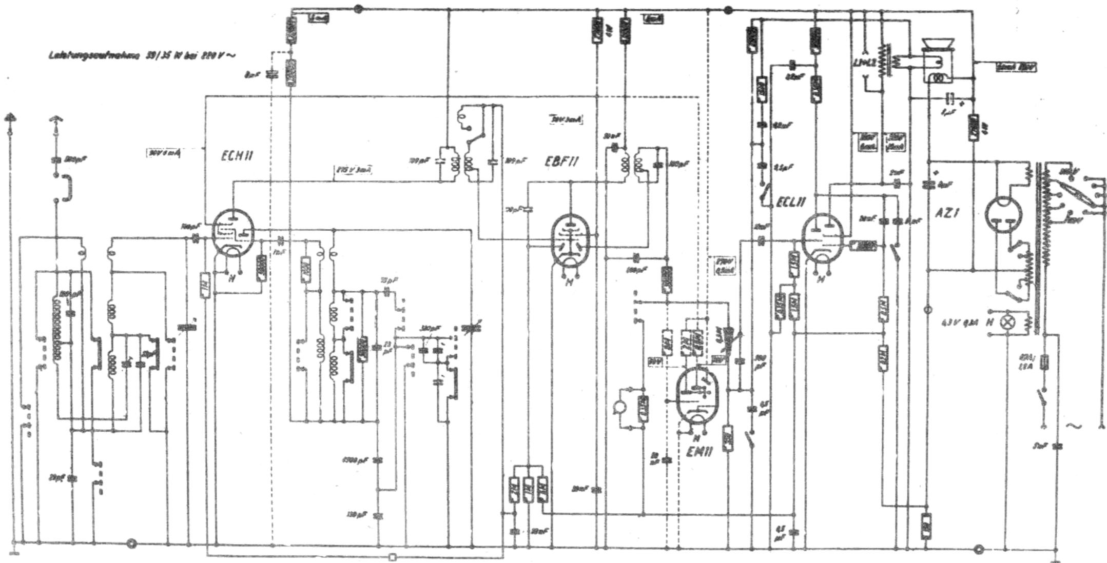
**Abb. 801. Schaltbild des „Loewe-Opta 540 W und 2540 W“ für Wechselstrom, Kenn-Nr. 29 A und 30 A**
