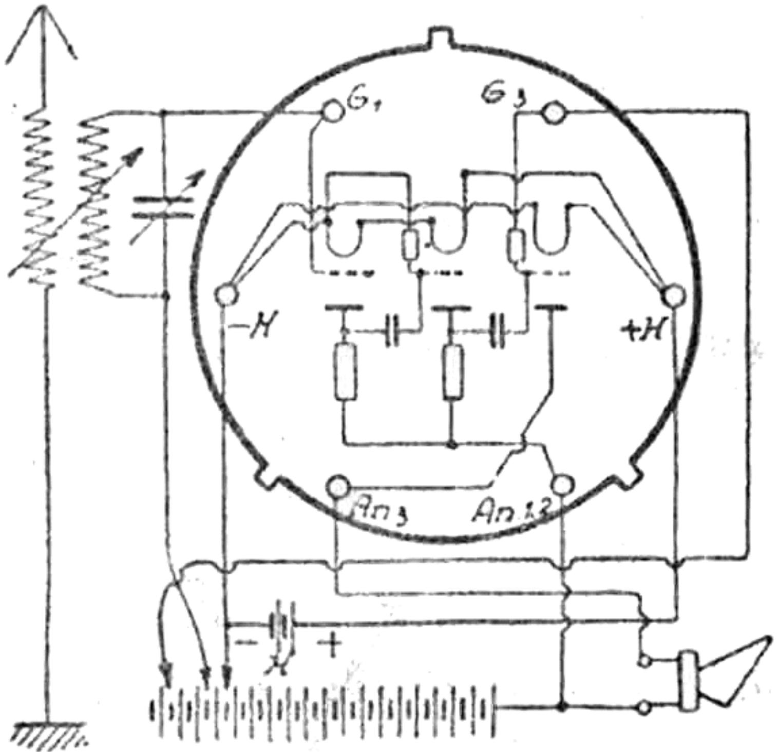
Erster integrierter Schaltkreis mit Heizung
