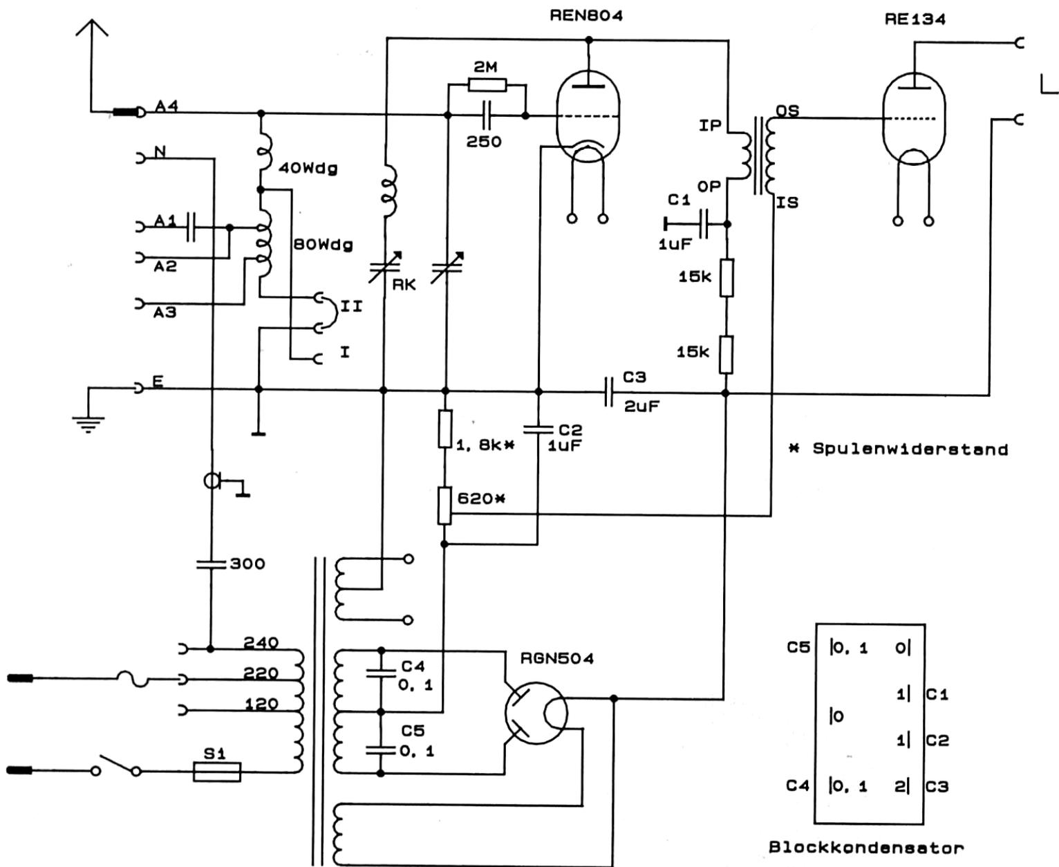
Schaltbild Nora K2Wb. Die Umschaltung des Wellenbereichs erfolgt durch Umstecken einer Kurzschlußbrücke. Die drei HF-Spulen sind Flachspulen, die von einem gemeinsamen Pertinaxstreifen gehalten werden.
