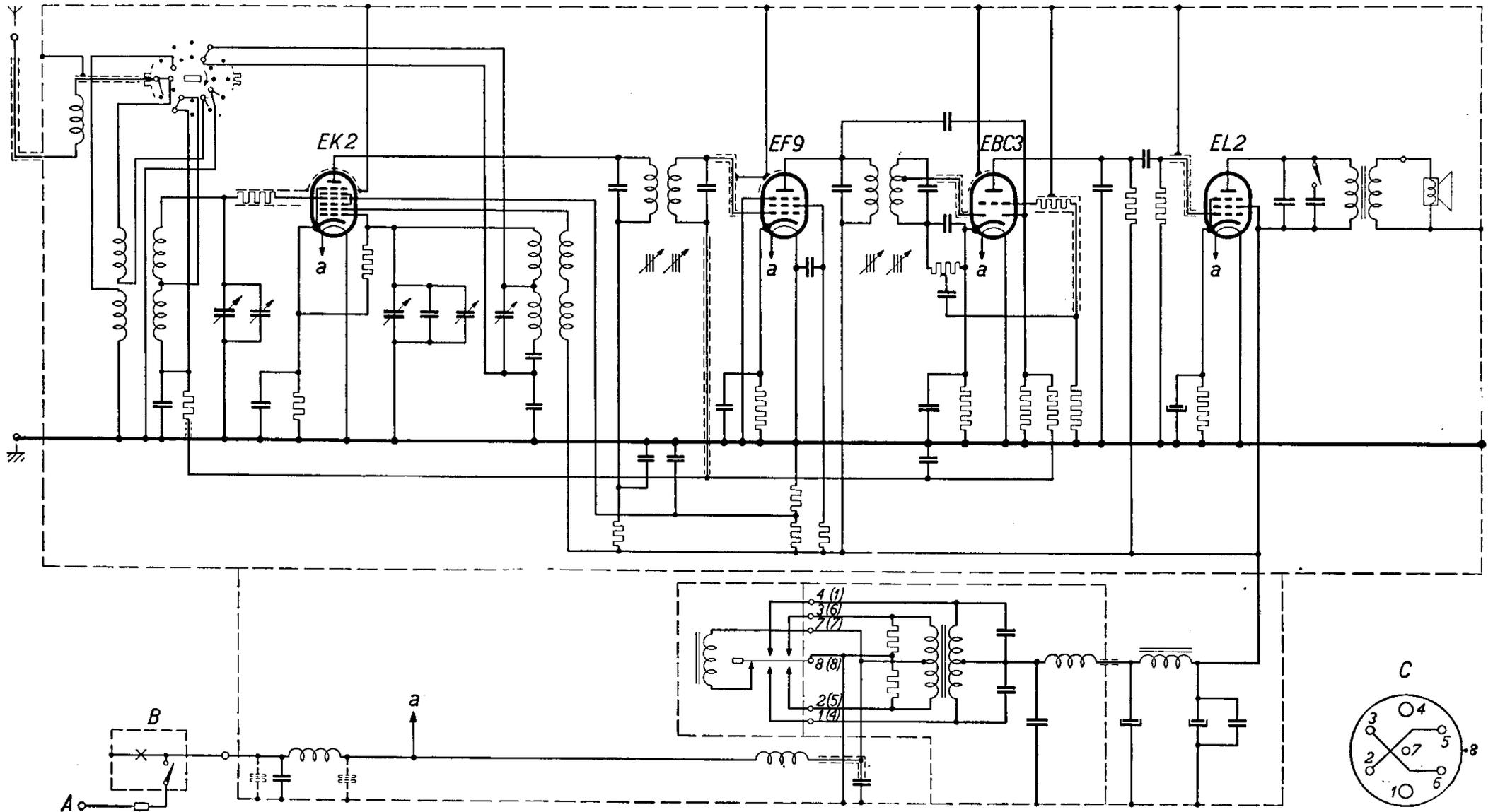
A est la borne de connexion pour l'accu de 6 V ; B est la boîte de commande. C indique les connexions aux broches de contact, on voit ainsi que lorsque le vibreur est tourné de 180°, seules les connexions à 1 et 4 sont interchangées, de sorte que la polarité de l'appareil est renversée.
