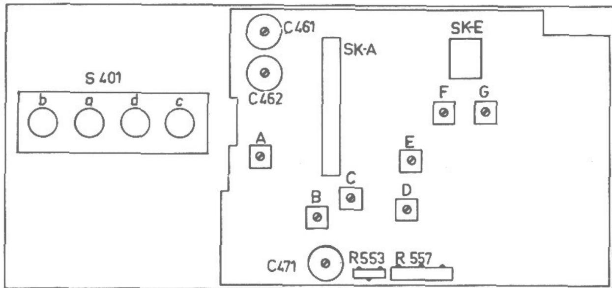
Ci-contre : disposition des ajustables du récepteur 22 RN 314. Ci-dessous : aspect extérieur du récepteur 22 RN 314.
