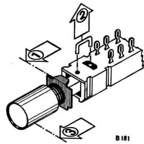
**Auswechseln eines Tastenschiebers**
