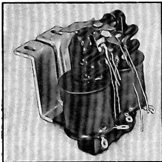
Le cœur de l'appareil est cet ensemble groupant un circuit magnétique formé de tôles empilées, traversant les deux bobines d'excitation et contre les branches duquel sont plaqués les trois bâtonnets de ferrite constituant les bobinages saturés. Le tout est enrobé de brai, d'où le peu de précision de la photo. Les chiffres repères correspondent à ceux du schéma général.
