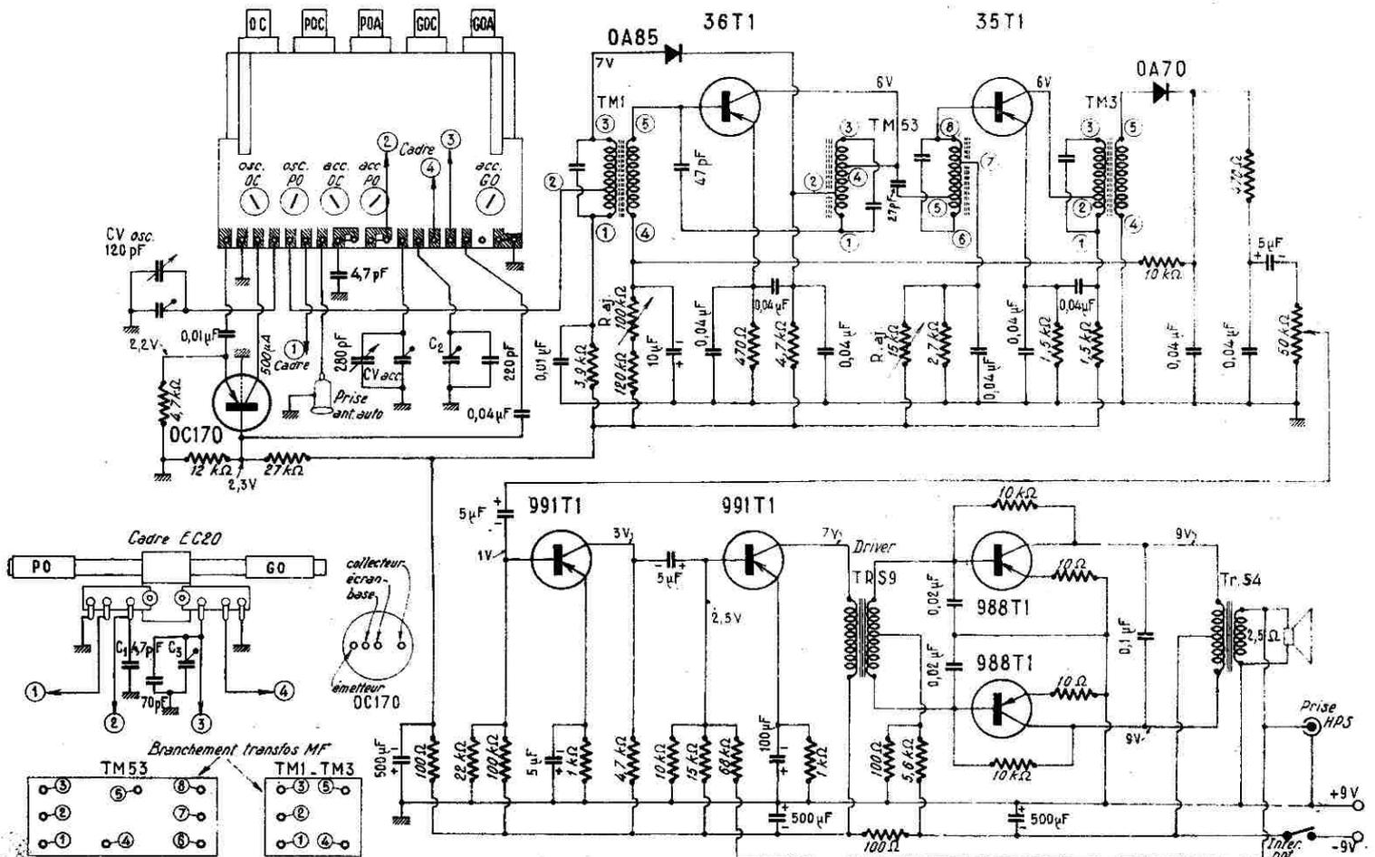
Pour la réception de la gamme OC, dans le cas de l'utilisation du récepteur comme poste portatif, une antenne télescopique est prévue. La sensibilité est bonne sur toute la gamme OC, le transistor oscillateur modulateur étant un OC170 dont la fréquence de coupure est élevée, ce transistor ayant été conçu pour équiper les récepteurs FM.
