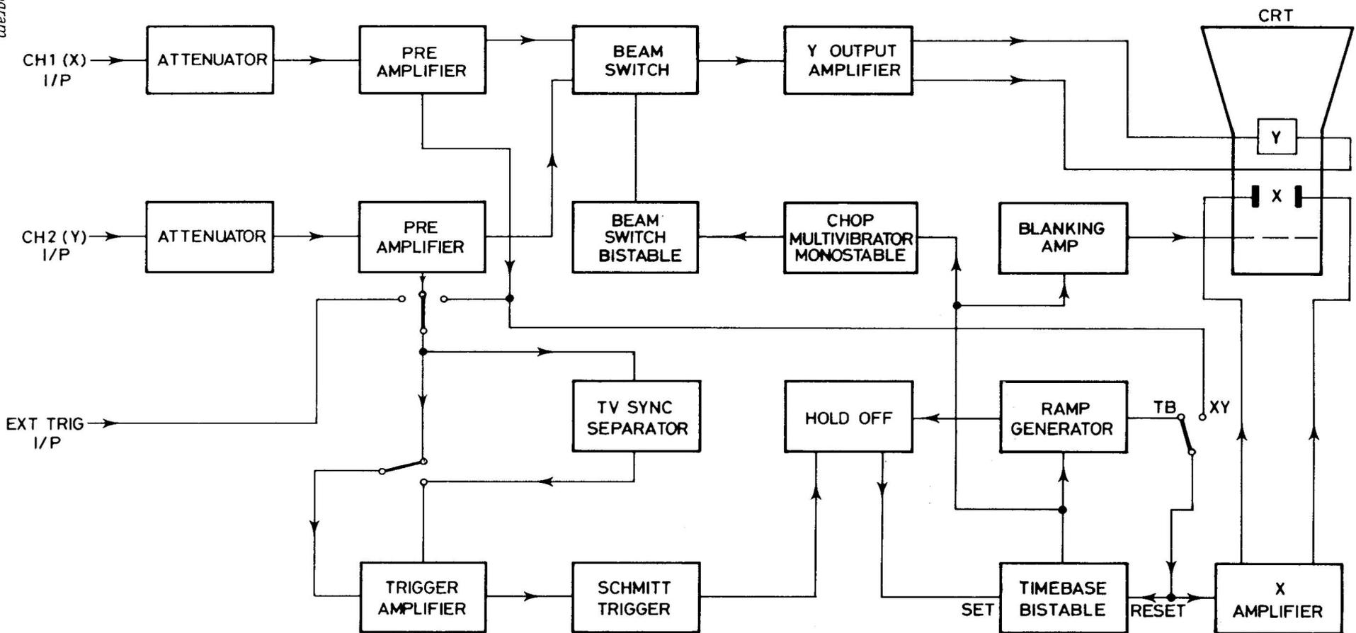
Fig. 1 Block Diagram
