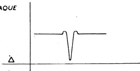
— Au voisinage de la synchronisation le courant plaque lu sur le microampèremètre augmente légèrement, diminue brusquement, passe par un minimum à la résonance exacte, remonte de nouveau jusqu'à la première valeur, puis décroît légèrement, jusqu'à sa valeur initiale.
