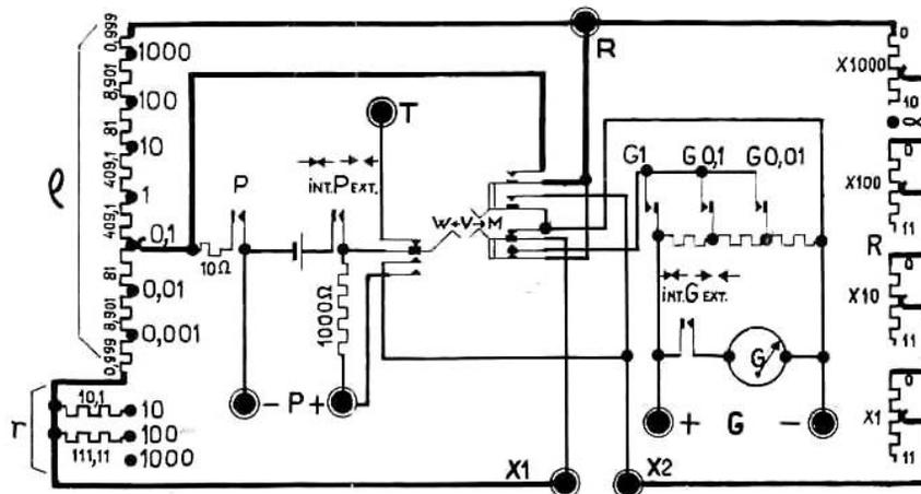
X étant l'inconnue à mesurer, il s'agit, une fois fixé le rapport du bras de proportion, de ramener l'aiguille du galvanoscope à sa position d'équilibre, en jouant sur le quatrième bras du pont.
