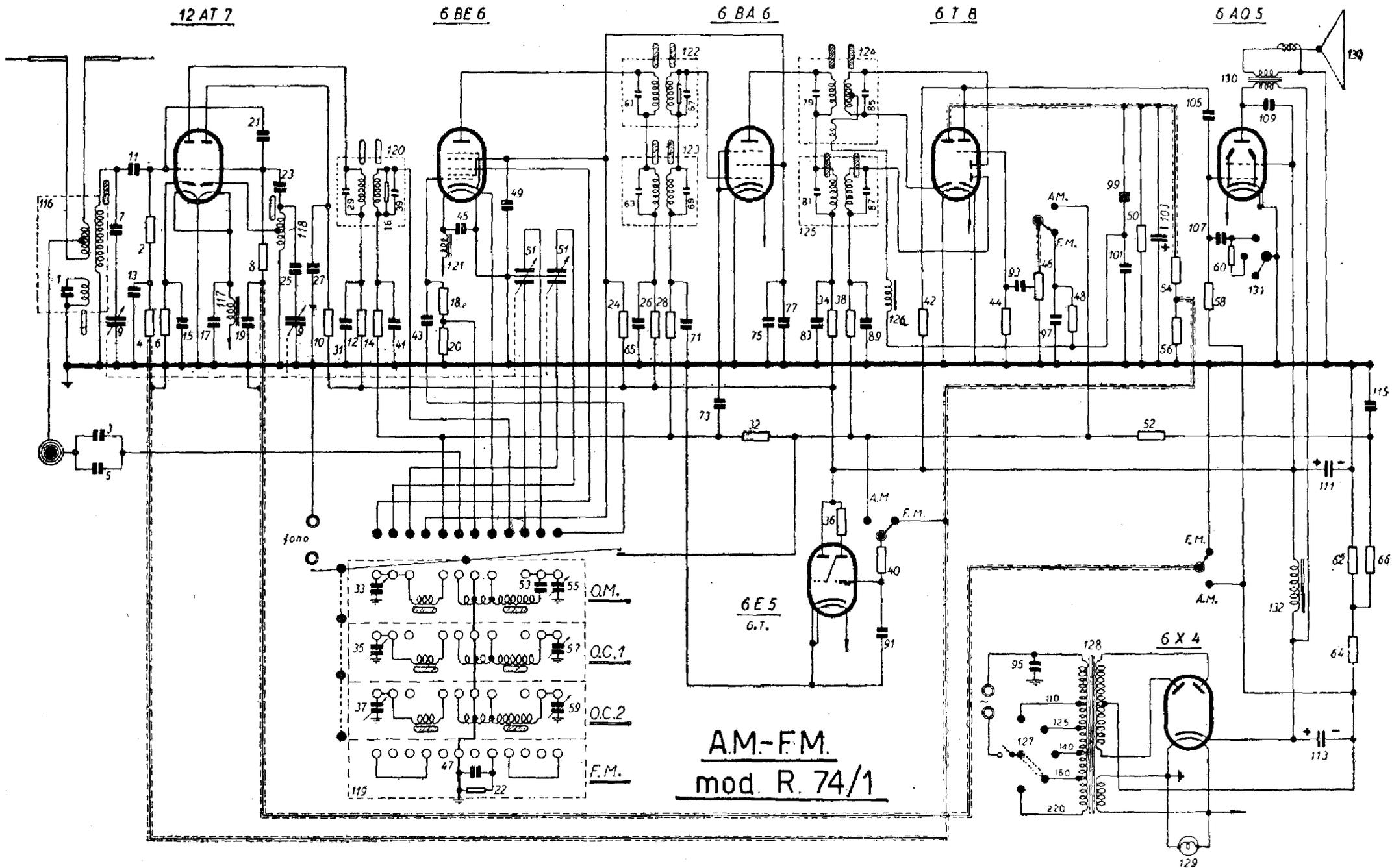
UNDA RADIO - Mod. AM/FM R. 74/1 - A modulazione d'ampiezza e di frequenza. La 12AT7 provvede alla conversione dei segnali FM. La 6BE6 provvede alla conversione dei segnali AM (onde medie e due corte) nonché all'amplificazione MF dei segnali FM, quando l'apparecchio è in posizione FM. Rivelatore FM a rapporto, con valvola 6T8 rivelatrice AF/FM e amplif. BF.
