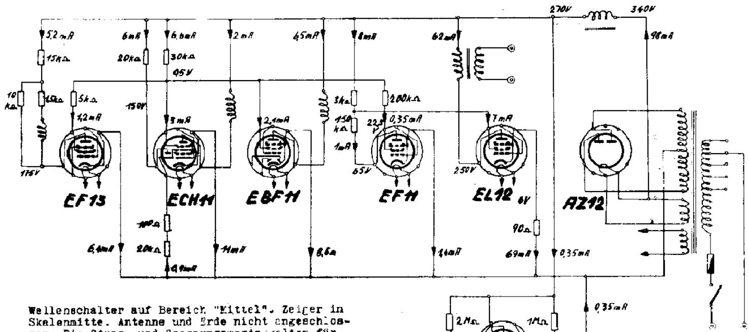
Wellenschalter auf Bereich "Mittel". Zeiger in Skalenmitte. Antenne und Erde nicht angeschlossen. Die Strom- und Spannungswerte gelten für betriebswarmes Gerät. Alle Ströme und Spannungen mit Multi-Z Instrument (300 Ohm/V) gemessen, Spannungen über 50 V mit dem 600 V Bereich. Die Gleichspannungswerte beziehen sich auf das Chassis. Röhrensockel von unten gesehen.
