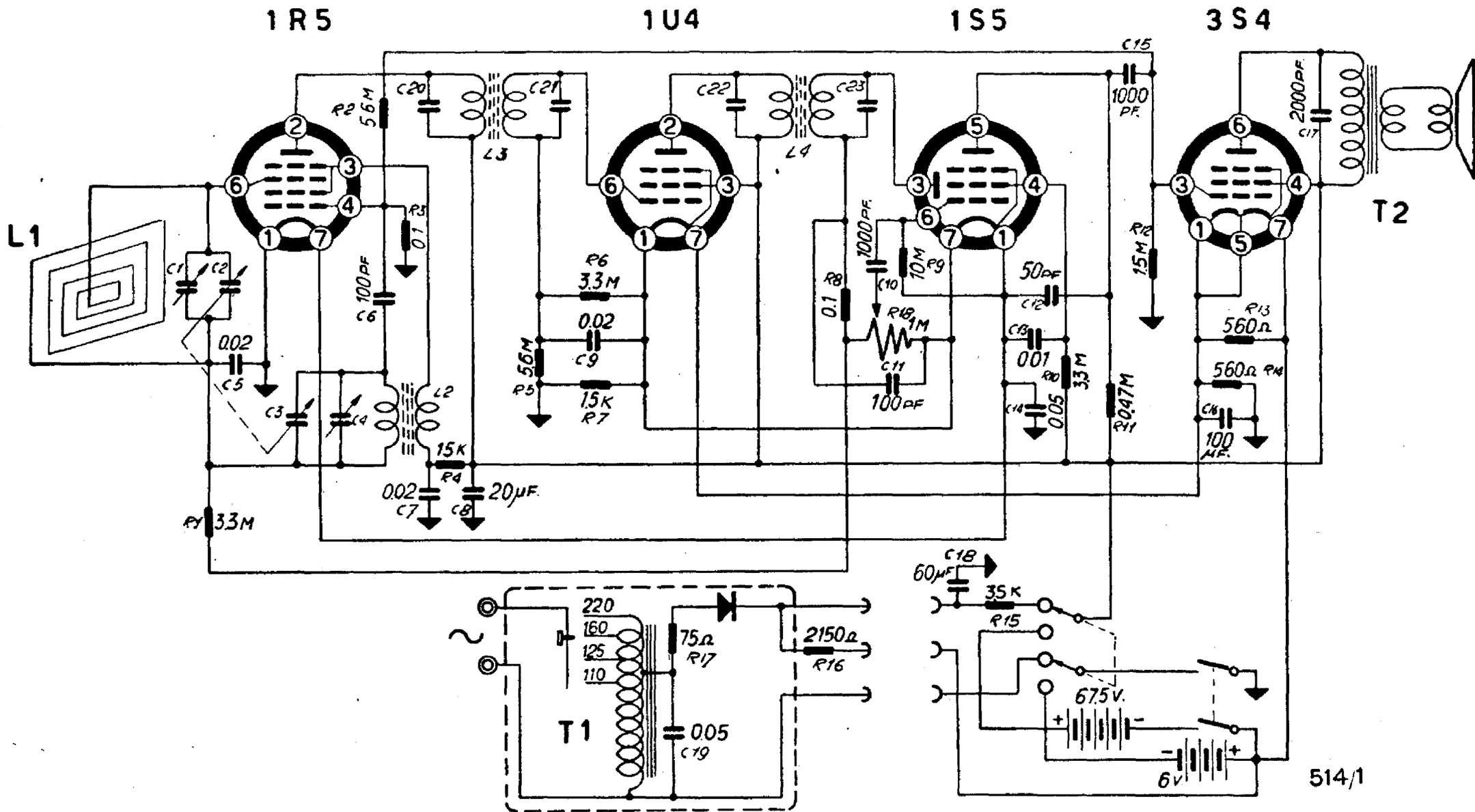
**MINERVA RADIO - Mod. 514/1 POCKET** - Apparecchio tascabile, alimentato con pile a secco, od anche con la tensione alterata della rete-luce. Provvisto di antenna a quadro, interna. Dimensioni 25×12×6,5 cm. Altoparlante di 8,8 cm. Media frequenza 468 kc. Consumo 13 watt quando alimentato in alternata.
