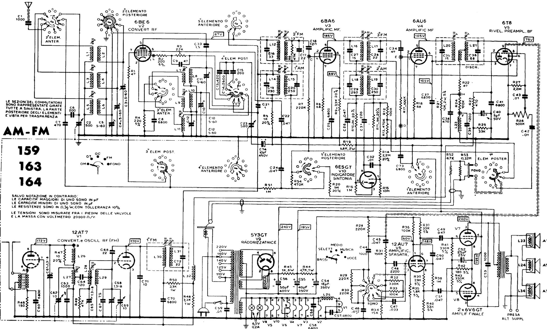
RADIO MARELLI - Modd. AM/FM 159, 163 e 164. I valori, i limiti di gamma e le istruzioni di taratura sono riportate a parte. Lo schema è del mod. 164; il mod. 163 è senza fonorivelatore; il mod. 159 è con fonorivelatore ma a un solo altoparlante. Potenza d'uscita 6,5 W. Consumo 78 W.
