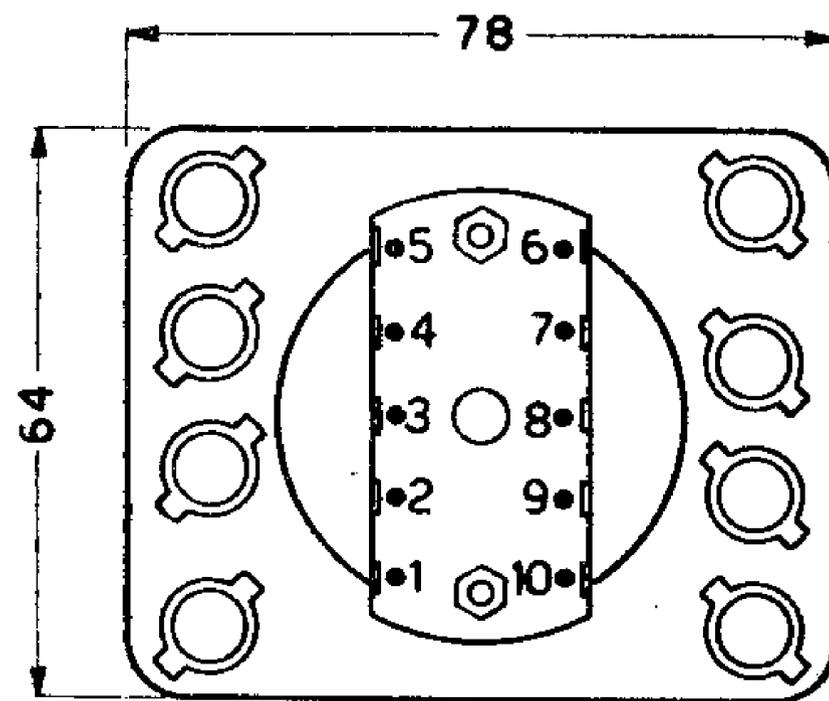
Dati d'ingombro e di foratura per il montaggio del Gruppo N. 2621.
