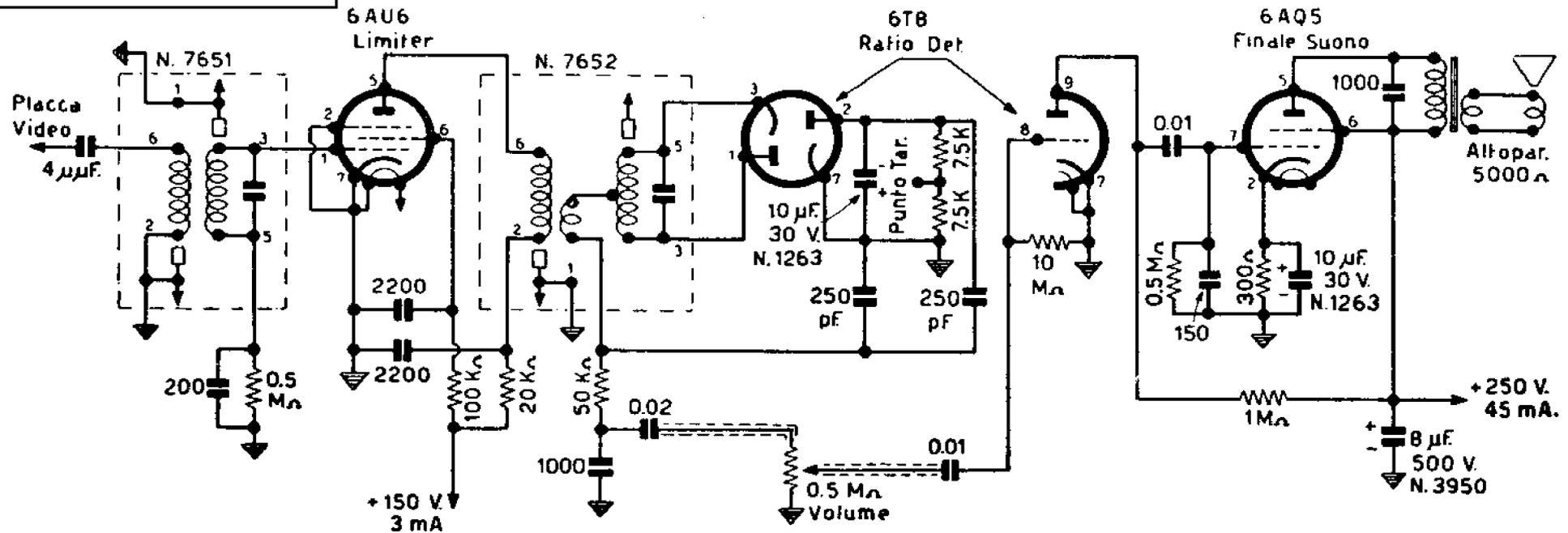
Schema elettrico completo dell'unità suono N. 7811. Grazie al sistema «intercarrier» questa sezione del televisore viene ridotta unicamente a questa semplice unità; si hanno così, oltre ad una semplificazione notevole, i diversi vantaggi di cui è detto nel testo.
