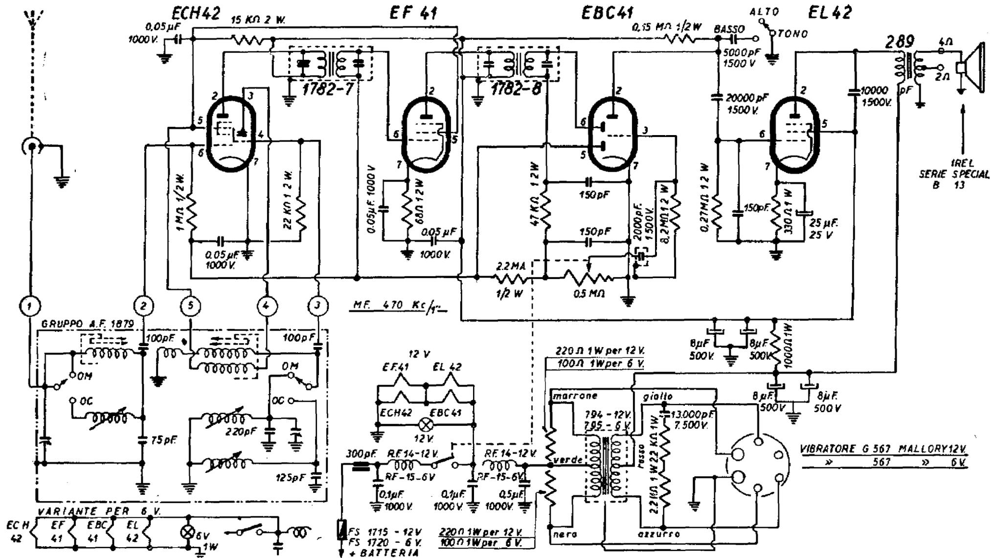
**GALLO-CONDOR . AUTORADIO mod. «CONDORINO».** Una gamma onde medie ed una gamma onde corte. Sintonia a permeabilità variabile. Media frequenza 470 kc/s. Alimentazione a 12 o 6 volt, con sostituzione del vibratore, del fusibile, delle resistenze sul primario del trasformatore, ed effettuando la commutazione dei filamenti.
