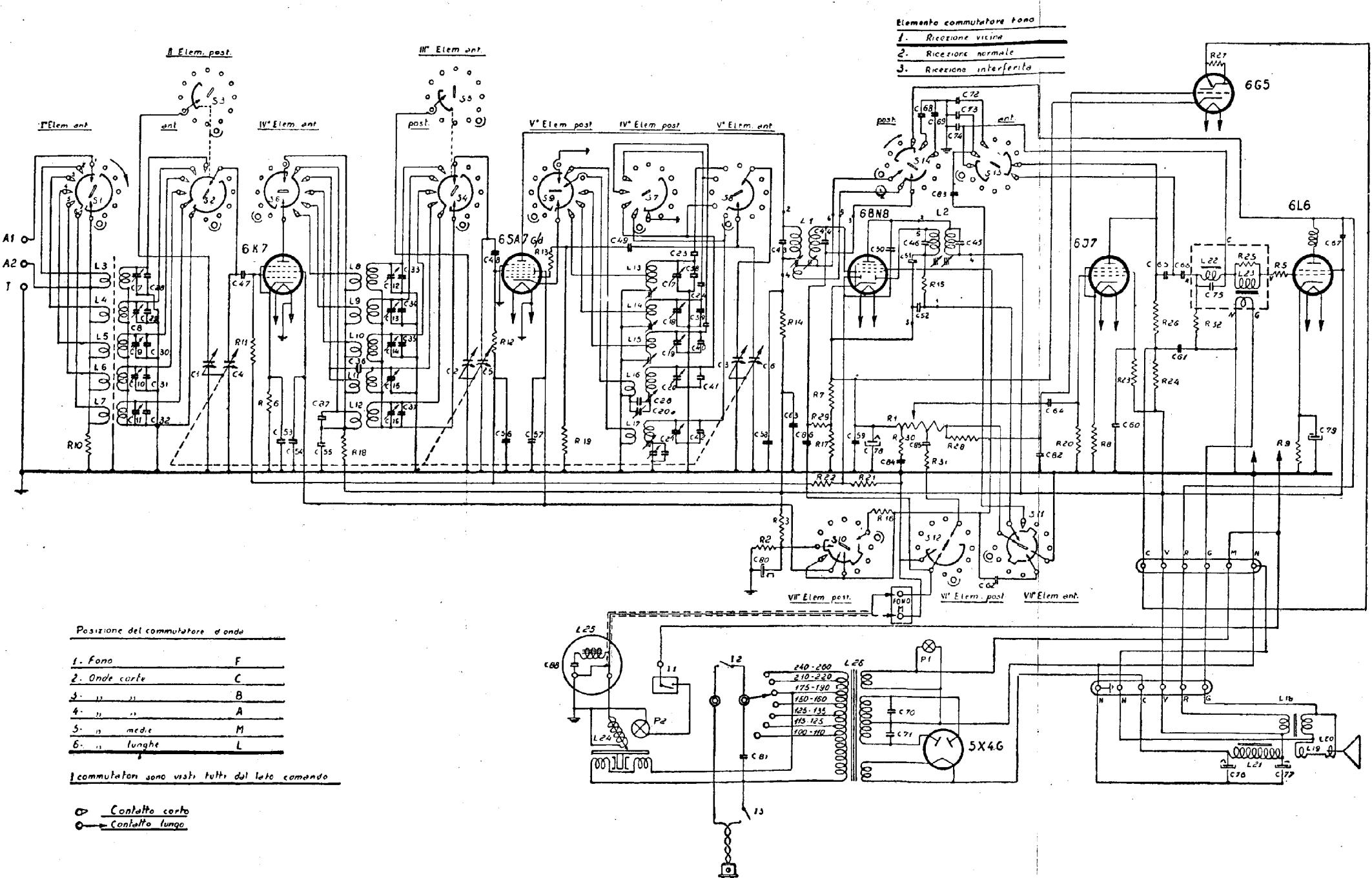
80. — RADIO MARELLI. — Mod. «Nilo Azzurro». — Produzione 1940-41. — Gamme: I. (1000-2000 m), m. (193-570 m), c. A (32-50 m), c. B (20-32 m), c. C (13-20 m). — Media frequenza: 470 kHz. — Potenza: d'uscita: indistorta 6 watt, massima 11 watt. — Alimentazione da 100 a 260 V. — Consumo (160 V 42 c/s) 0.65 A.
