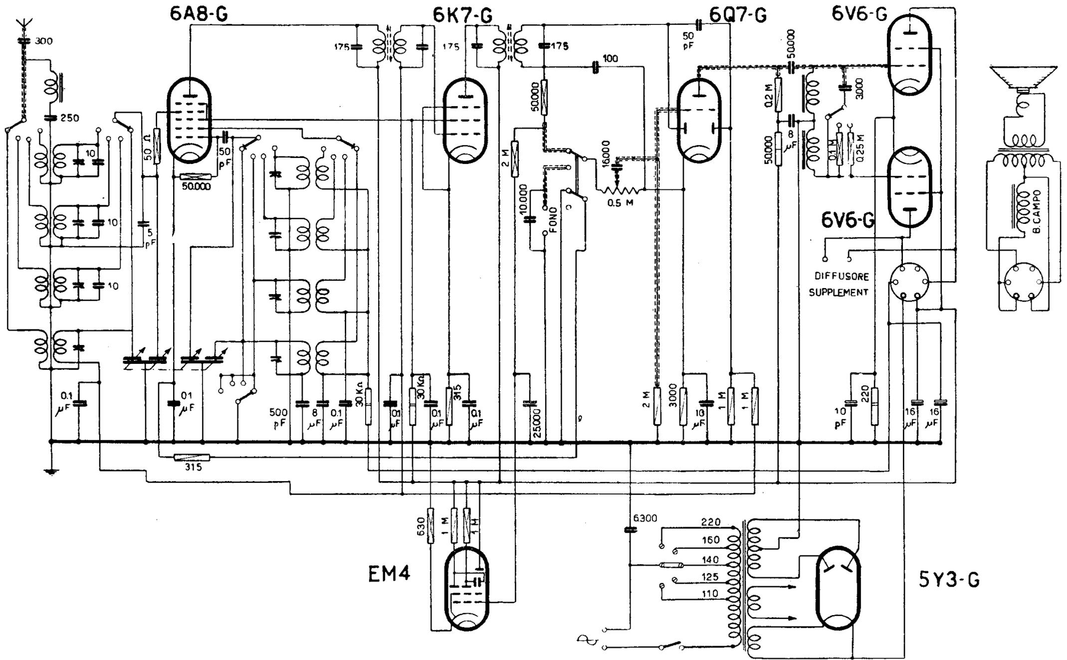
DUCATI - Mod. RR 3702 - In basso, a sinistra dello schema, v. sezione commutatore per messa a massa. Gamma medie intere, gamma corte divisa in tre parti. Media frequenza: 468 kc/s.
