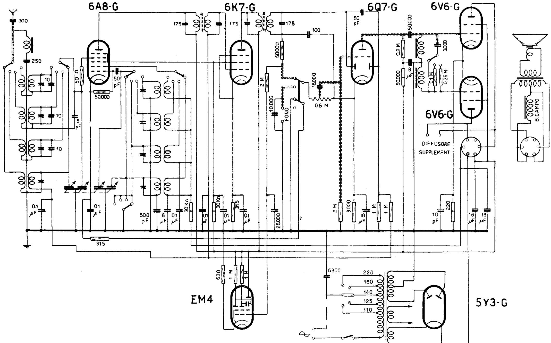
DUCATI · Mod. RR 3702 · In basso, a sinistra dello schema, v. sezione commutatore per messa a massa. Gamma media intere, gamma corte divisa in tre parti. Media frequenza: 468 kc/s.
