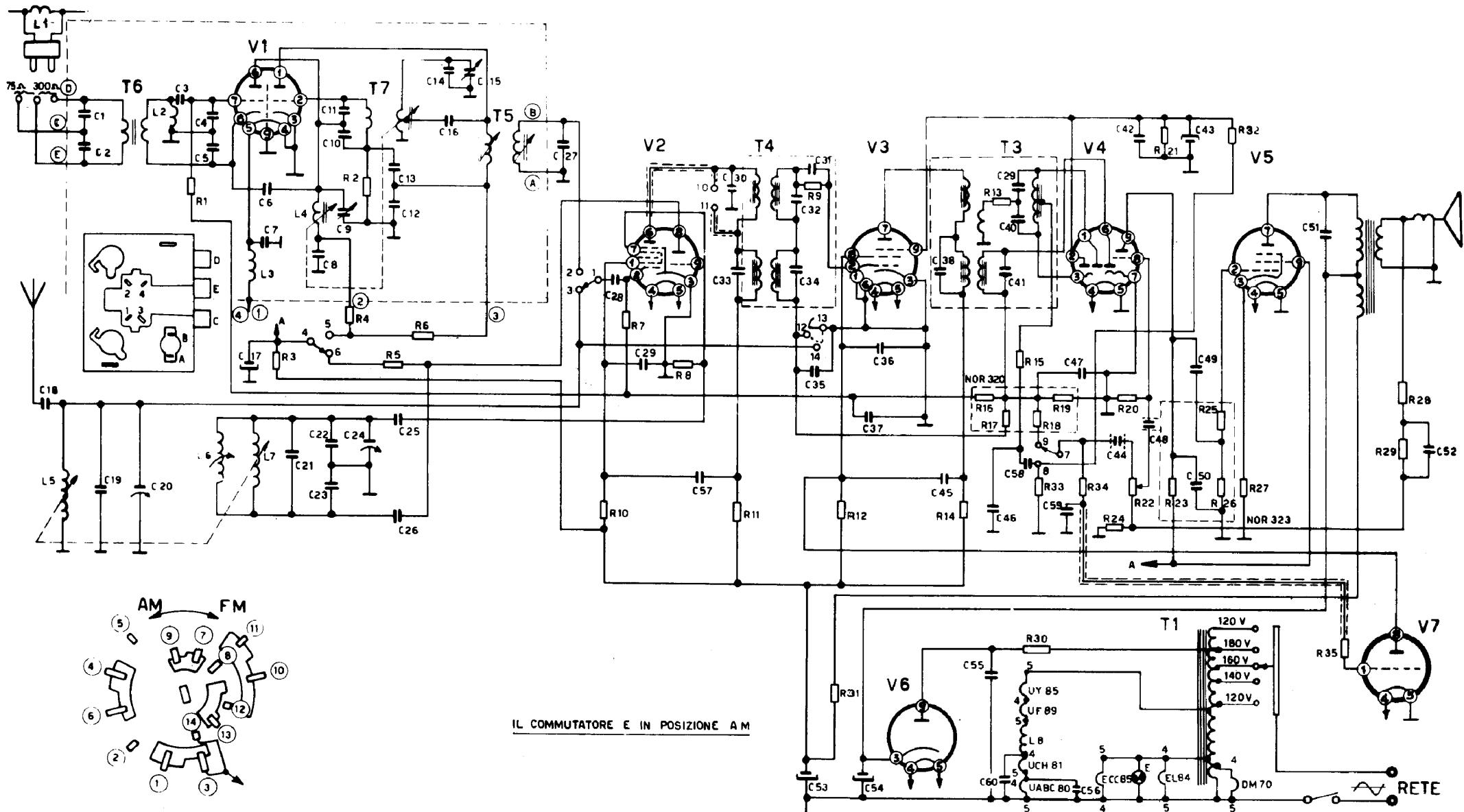
COMPAGNIA GENERALE DI ELETTRICITÀ - Apparecchio Mod. CGE 2587 SUPER RADIETTA. Gamma onde medie a modulazione di ampiezza e gamma onde ultracorte a modulazione di frequenza. Medie frequenze a 468 kc/s e a 10,7 Mc/s. Potenza d'uscita 2 watt.
