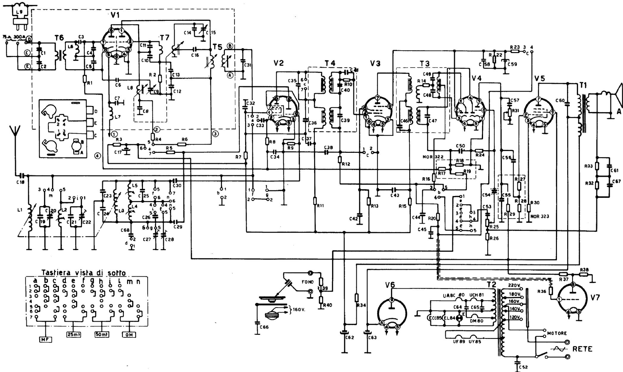
COMPAGNIA GENERALE DI ELETTRICITÀ - Apparecchio Mod. CGE 3587 JOLIE. Gamma onde ultracorte a modulazione di frequenza. Medie frequenze a 468 kc/s e a 1
