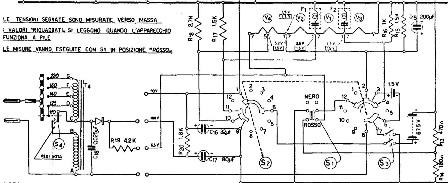
**NOTA** QUANDO L'ALIMENTATORE VIENE PREDISPOSTO PER LA TENSIONE DI 110V (CORRENTE CONTINUA O CORRENTE ALTERNATA) MEDIANTE L'APPOSITA VITE A TESTA ISOLANTE, LA VITE STESSA PROVOCA L'APERTURA DI S4, CHE INVECE RISULTA CHIUSO NELLE ALTRE POSIZIONI DEL CAMBIO-TENSIONI
