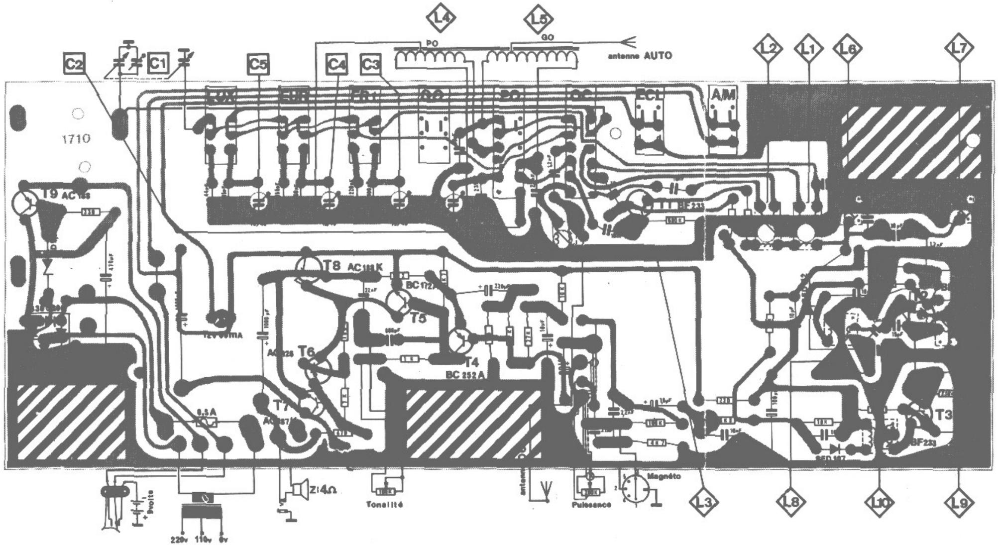
Implantation des éléments sur la platine imprimée et, en bas, les connexions des différents transistors utilisés. Les tensions normales sont indiquées sur le schéma général.
