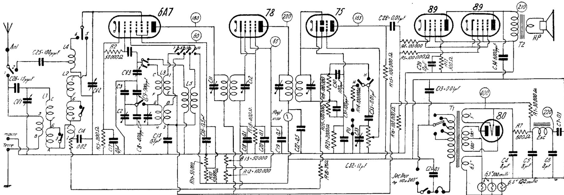
Les ajustables du second transformateur M.F. doivent être numérotés respectivement : C23 (primaire) et C24 (secondaire). Le condensateur C3 est ajustable.
