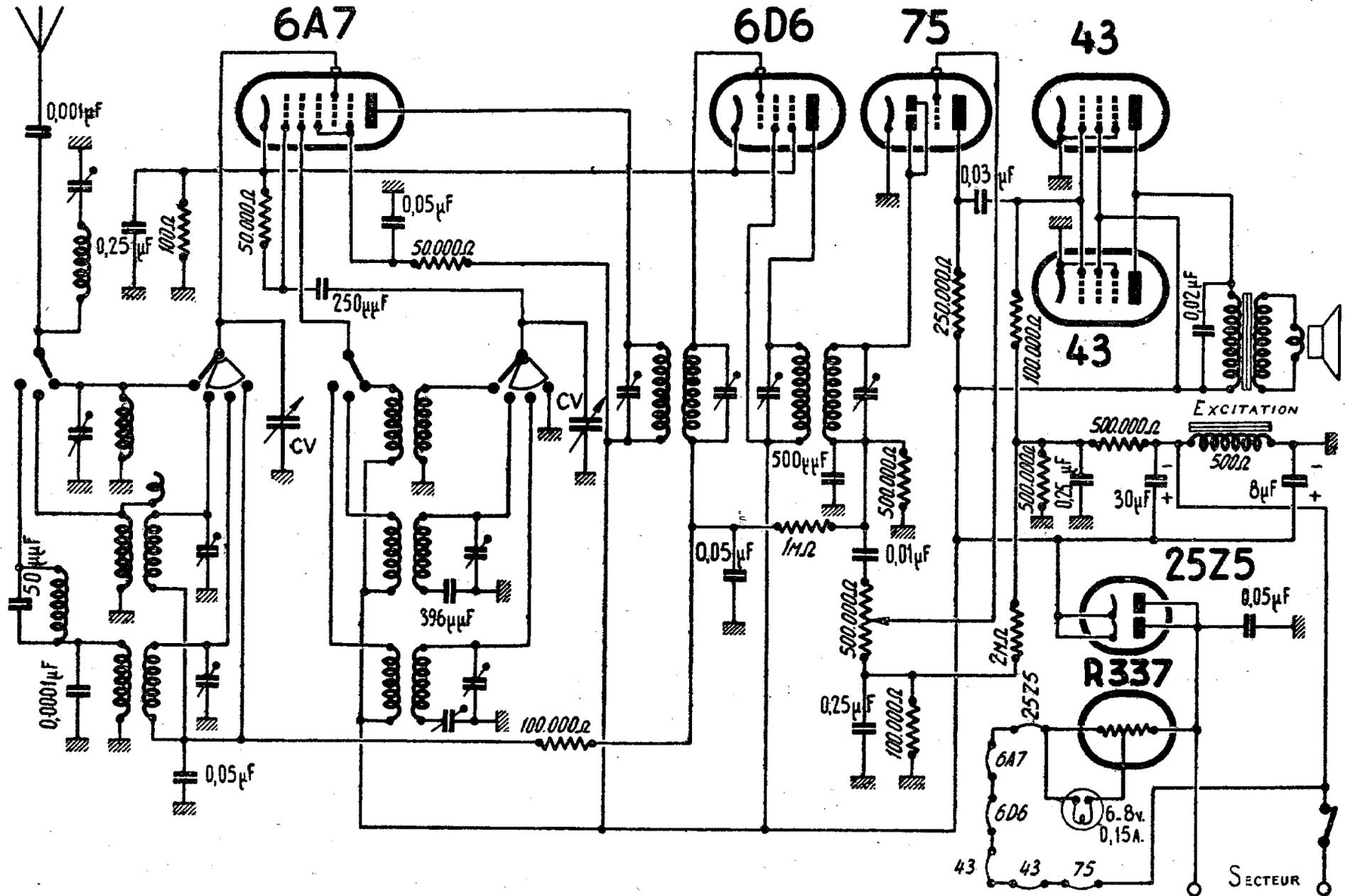
Schéma général du récepteur EL87. Les deux lampes 43 finales sont montées en parallèle. Les transformateurs M.F. sont accordés sur 448 kHz.
