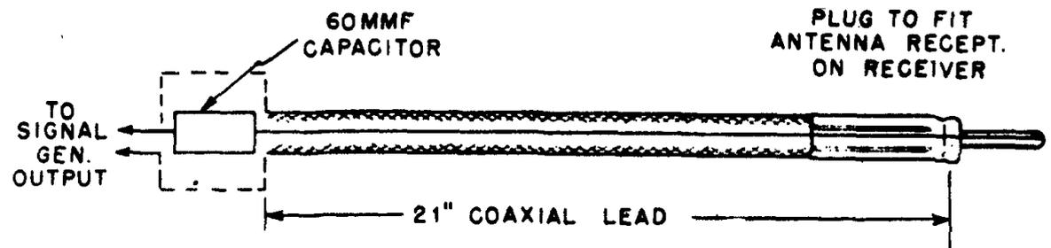
DUMMY ANTENNA CONSTRUCTION-DETAIL
