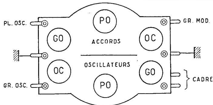
Ci-contre, à gauche, disposition des ajustables sur le bloc de bobinages du récepteur 662.
