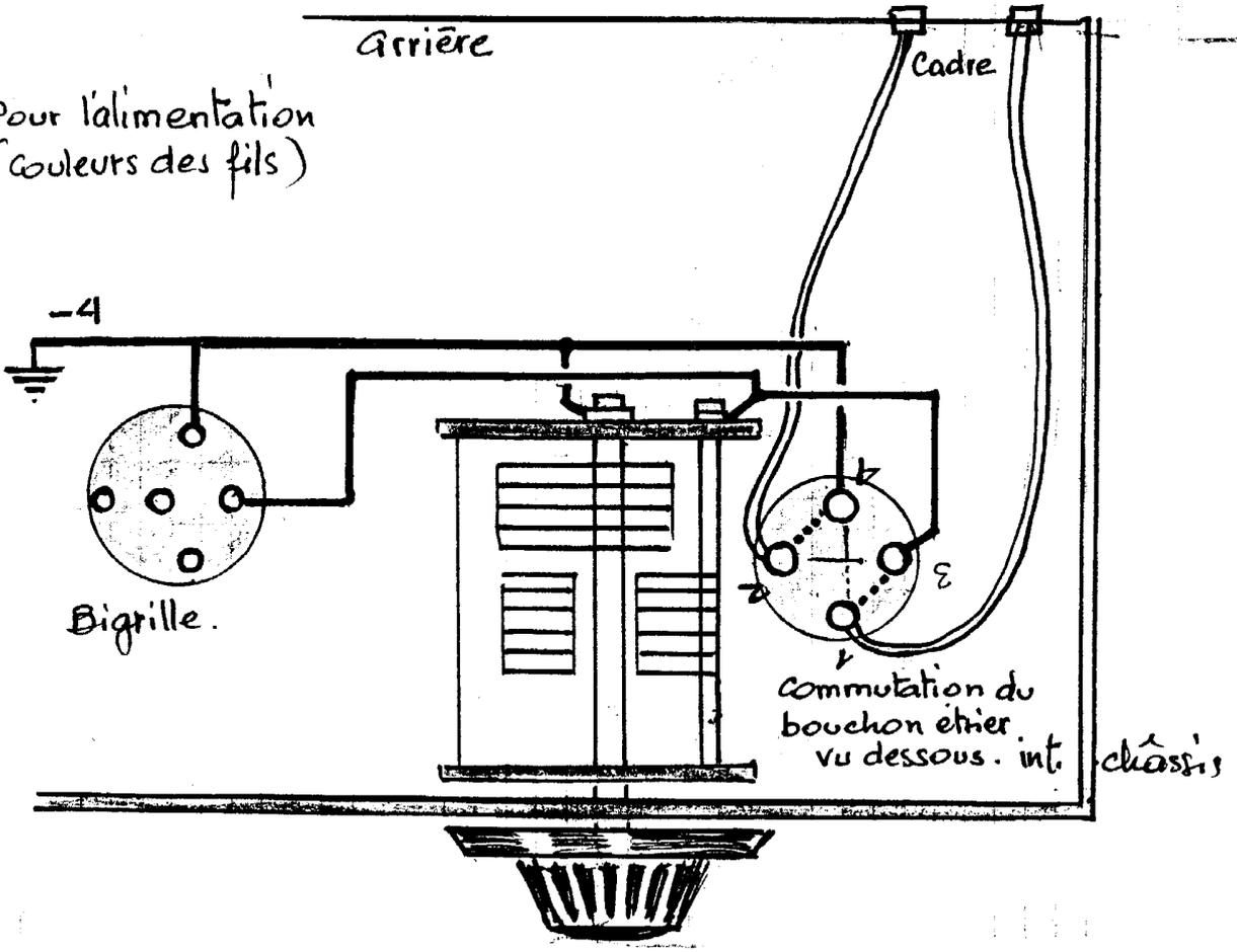
Schéma d'entrée avec commutation du bouchon-étrier pour Cadre
