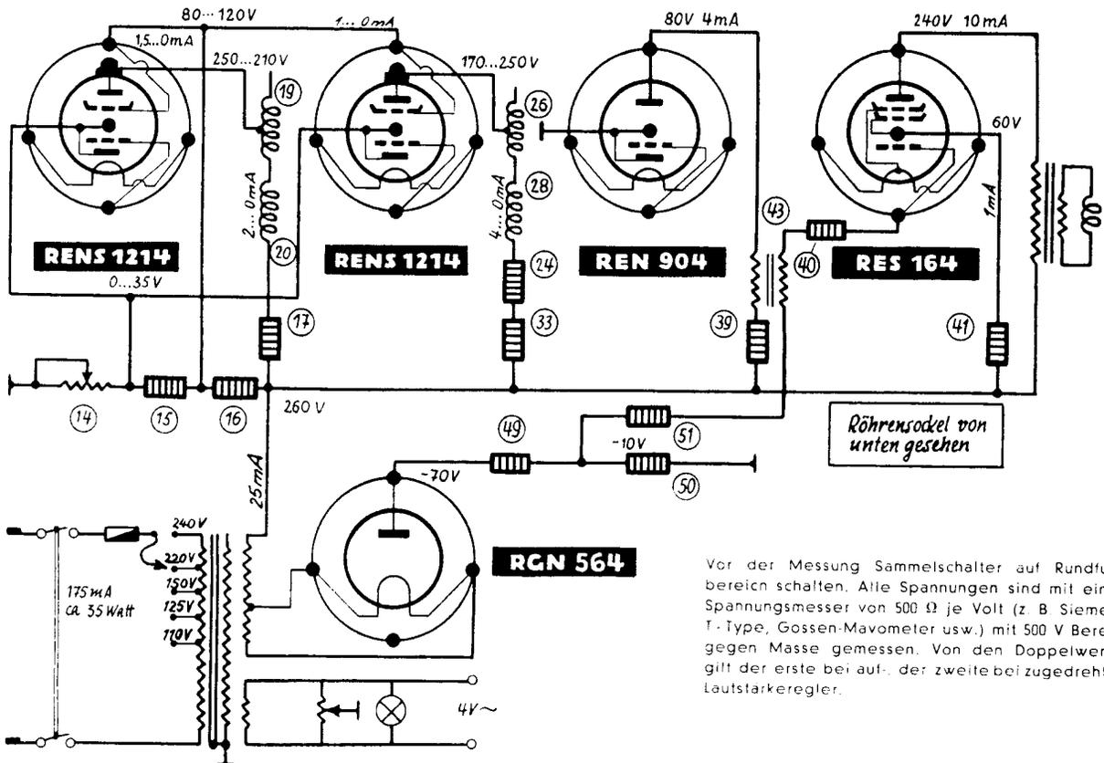
Vor der Messung Sammelschalter auf Rundfunkbereich schalten. Alle Spannungen sind mit einem Spannungsmesser von 500  $\Omega$  je Volt (z. B. Siemens-T-Type, Gossen-Mavometer usw.) mit 500 V Bereich gegen Masse gemessen. Von den Doppelwerten gilt der erste bei auf-, der zweite bei zugeordnetem Lautstärkereglern.
