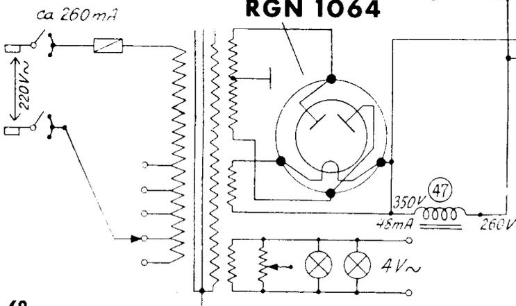
Vor der Messung Sammelschalter auf Rundfunkbereich schalten und Rückkopplungsknopf nach links drehen. Alle Spannungen sind mit einem Spannungsmesser von 500  $\Omega$  pro Volt (z. B. Siemens-T-Type, Gossen-Mavometer usw.) gegen Masse gemessen. Von den beiden Werten an der RENS 1294 gilt der erste bei auf-, der zweite bei zugedrehtem Lautstärkeregl.
