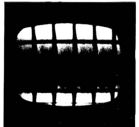
11 - Barres épaisses et sombres. Tension de gonflement dans le signal Image, défaut du tube cathodique Ecran.
