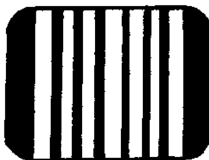
Fig. 174. — Les bords extrêmes du tube ne sont pas balayés.
