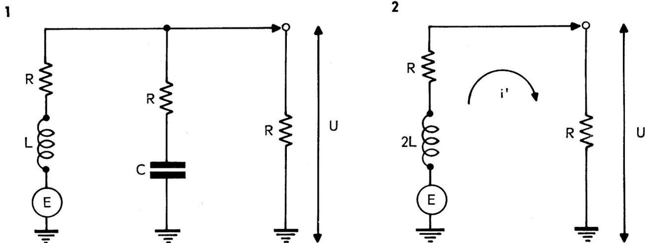
Le schéma (1) peut être mis sous la forme (3)
