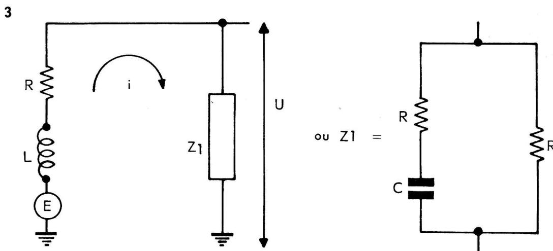
E est la source électromotrice représentant l'énergie UHF fournie par le générateur.
