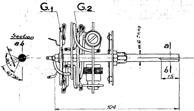
**ATTENTION** à l'orientation de la rainure de l'axe de commande. Combinateur représenté en position de butée à droite (P.U.)
