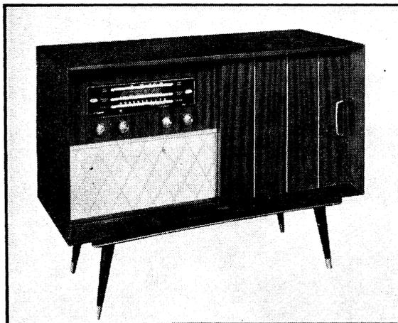
Voici un meuble radio-phon. assez caractéristique pour l'industrie anglaise. Il est équipé d'un châssis 6 lampes prévu pour recevoir la FM, en dehors des gammes normales, et comporte une antenne-ferrite ainsi qu'un dipôle incorporé pour la réception de la FM. Le haut-parleur est un 25 cm à champ magnétique intense. L'ensemble est complété par une platine tourne-disques à quatre vitesses
