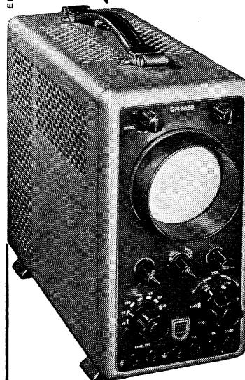
Amplification verticale: 0 à 4,5 Mc : s (100 mVeff/cm), utilisable jusqu'à 10 Mc : s, corrigé en phase pour l'étude des impulsions de télévision.
