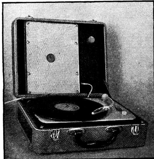
Le haut-parleur, du type inversé et de 17 cm de diamètre, est fixé dans le couvercle détachable. La puissance de sortie de cet amplificateur est de 1,3 W environ à 400 Hz, avec une distorsion de 10 %.
