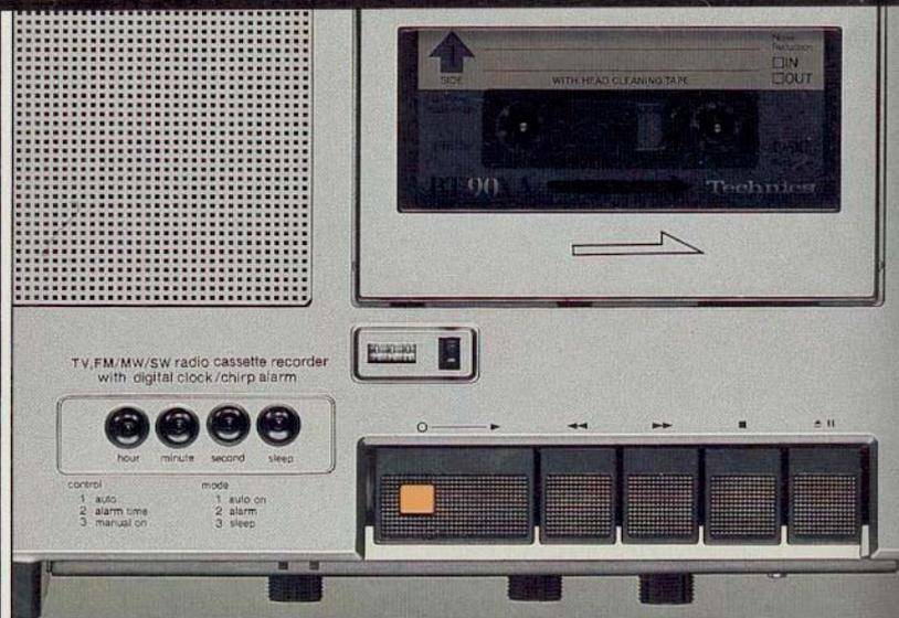
Bedienelemente für Weckuhr und Cassettenrecorder zusammengefaßt an der Geräteoberseite.
