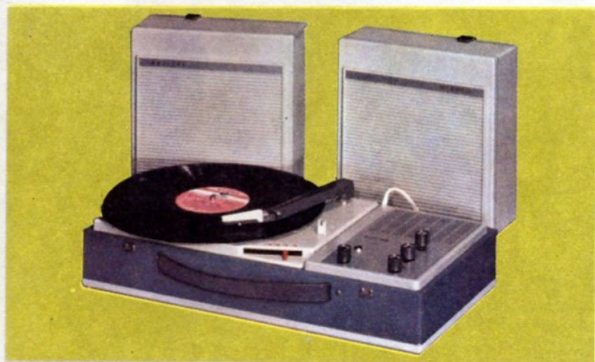
AG 4956 - Électrophone stéréophonique - Tête Diamant - Haut-parleur de 16 cm dans chaque demi-couvercle. Équipé de deux amplificateurs. Tonalité et balance sonore réglables. Puissance de sortie : 3,4 watts. Mallette en bois gainé, gris/bleu. L. 485 x H. 180 x P. 250 mm.
