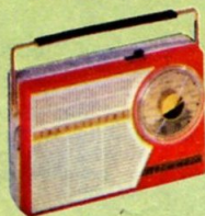
A21 T/01 - 2 gammes (PO-GO). 6 transistors, 1 diode. Alimentation : 1 pile 9 V. Coffret gainé gris, rouge. Sacoche sur demande. L. 200 x H. 125 x P. 55 mm.
