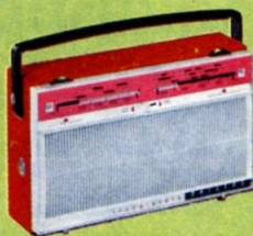
L3F28 T - 2 gammes (PO-GO). Prises : antenne auto (avec élimination du cadre), écouteur personnel. 6 transistors, 2 diodes. Alimentation : 2 piles 4,5 V. Coffret gainé rouge, gris, bleu. L. 260 x H. 160 x P. 80 mm.
