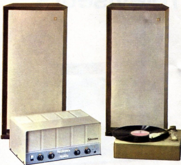
AG 9015 - Stéréo - Tête diamant - Chaîne Haute-Fidélité. Tourne-disques semi-professionnel (AG 1116) 4 vitesses, à changeur automatique 45 tr/mn. Tête magnétodynamique stéréo. Amplificateur double (2 x 15 watts). Réglages indépendants pour graves et aigus. Distorsion : 1 %. Entrées stéréo pour magnétophone, tuner, pick-up. L. 400 x H. 185 x P. 288 mm. Deux colonnes acoustiques avec haut-parleur bicoône haute fidélité 21 cm. L. 350 x H. 735 x P. 190 mm. Cette chaîne haute-fidélité peut être vendue en éléments séparés.
