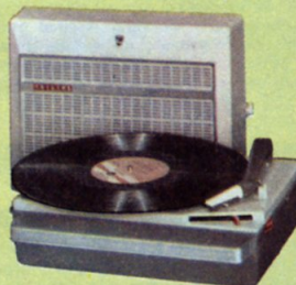
AG 4126 T - Transistors - Tête Diamant - Electrophone à piles. 4 vitesses. Haut-parleur 16 cm dans le couvercle. Puissance élevée : 2 watts. Tonalité. Prise stéréo. Alimentation : 6 piles torches. Coffret matière moulée anti-choc. Gris clair/gris foncé, gris clair/rouge. L. 335 x H. 165 x P. 278 mm.
