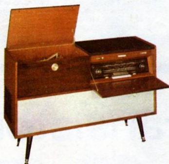
F8X12 AM/FM - Meuble radiophonograph « bi-ampli » stéréo - 4 gammes (PO-GO-OC-FM). Réglage de tonalité. Equilibrage sonore. 4 haut-parleurs à haute impédance de grandes dimensions dont 2 bicônes. Cadre antiparasites orientable. Accord gyroscopique. Unité de réverbération. 13 tubes. Prises doubles : magnétophone, haut-parleurs supplémentaires. Changeur automatique 4 vitesses. Noyer poli. L. 1.100 × H. 710 × P. 300 mm.
