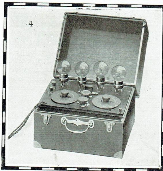
Récepteur Superstandard à résonance de la Société française radioélectrique, monté avec quatre lampes normales.
