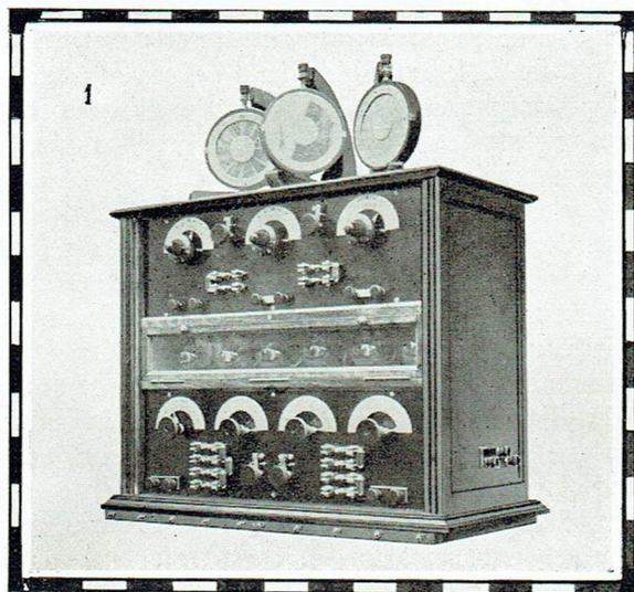
Amplificateur à self-inductances, avec variomètre suspendu à la Cardan, de l'Électro-Matériel.
